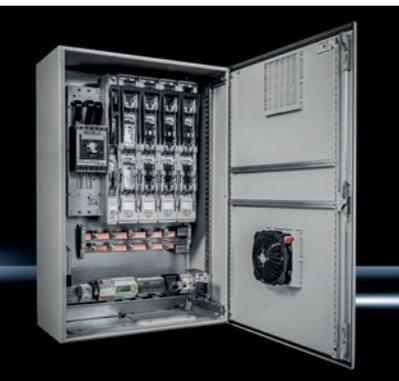
Rittal bietet speziell für Photovoltaikanlagen mit mehr als 30 kVA im Netzparallelbetrieb einen neuen AC-Verteiler auf Basis des Kompakt Schaltschranks AX. Der Aufbau des Steuerteils erfolgt unabhängig vom Schaltschrank auf getrennt einsetzbarem Chassis. Das Engineering und die lückenlose Dokumentation erfolgt durch Rittal-Softwaretools.
